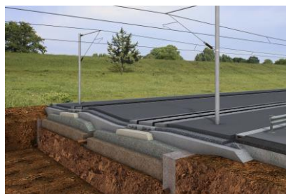
Feste Fahrbahn im Bereich der Rettungsplätze
